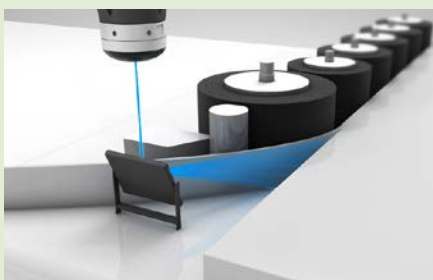
Paso 1: Soldadura de RAUKANTEX pro
